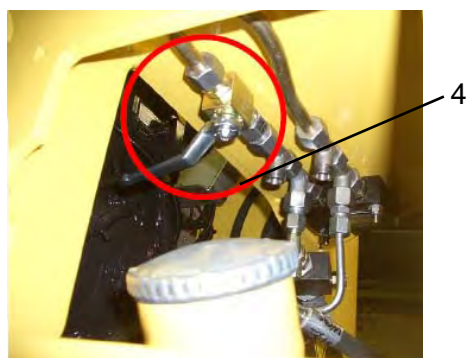
Рис. 4. Шаровой клапан в закрытом положении
