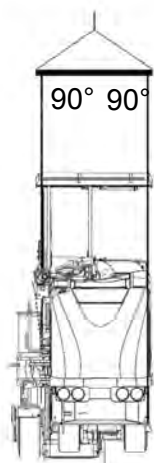
Fig. Maskin förberedd för lyft, vy framifrån
