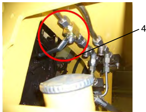
Fig. 4. Kulventil - i läge stängd
