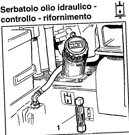
Fig. 6 Serbatoio olio idraulico 1 Vetro di ispezione
