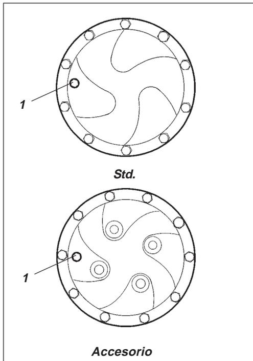
**Fig. 40 Engranaje planetario / situación de llenado**
