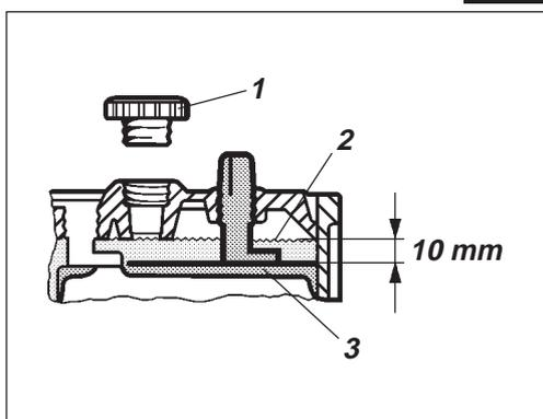
**Fig. 30 Nivel de electrolito en la batería**
