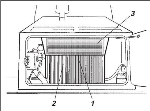
**Fig. 26** *Enfriador del aceite hidráulico*
