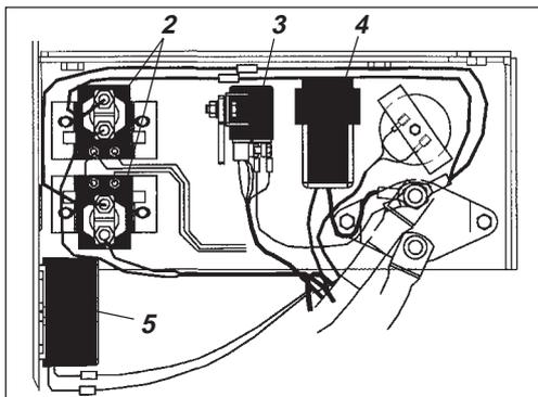
**Fig. 52** Vista posterior de la caja de relés (motor Cummins – fase 2)
