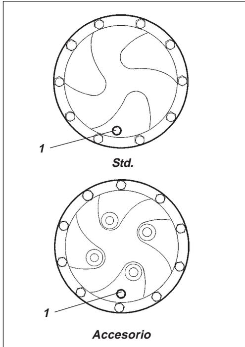
**Fig. 39 Engranaje planetario / situación de vaciado**
