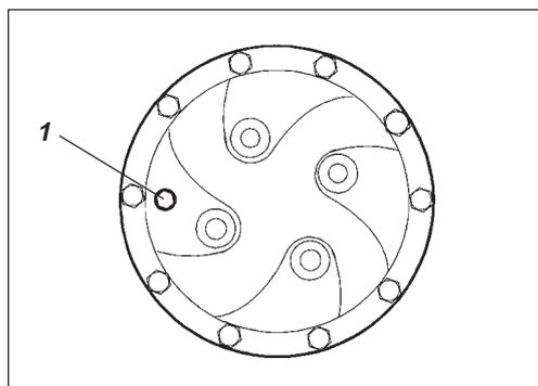
**Fig. 20 Control de nivel – engranaje planetario, accesorio**
