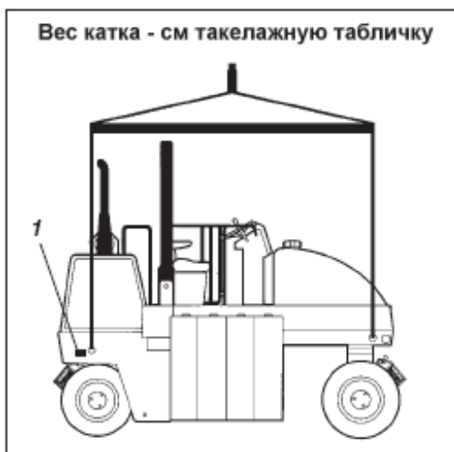
Рис. 27. Подготовленный к подъему каток 1. Такелажные таблички
