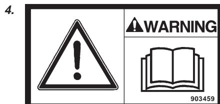
Σύσταση στον οδηγό να διαβάσει το βιβλίο ασφαλείας και τις οδηγίες οδήγησης και συντήρησης πριν τη χρήση του μηχανήματος.
