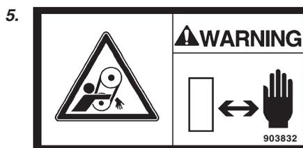
Attention aux courroies trapézoïdales mobiles. Tenir les mains à une distance prudente des zones à risque.
