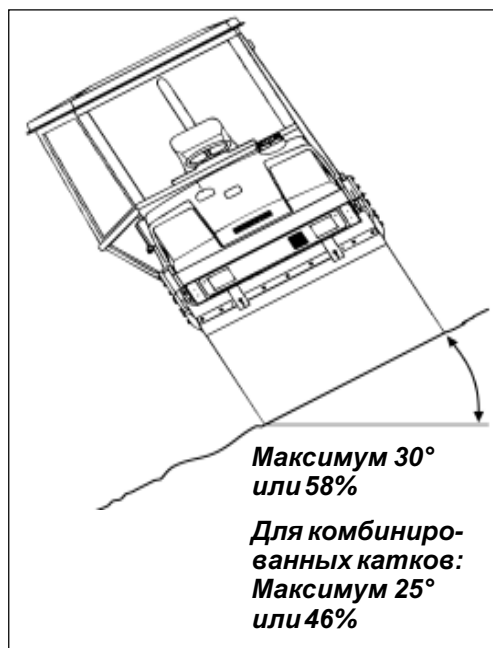
Рис. 21. Угол опрокидывания при движении катка по откосу
