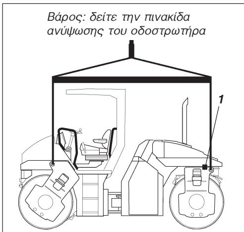
Εικ. 33 Οδοστρωτήρας προετοιμασμένος για ανύψωση
