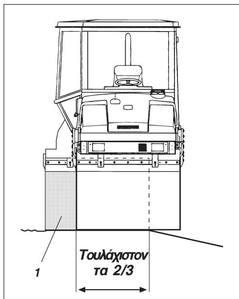
Εικ. 1. Θέση κυλίνδρων σε οδήγηση σε áκρο
