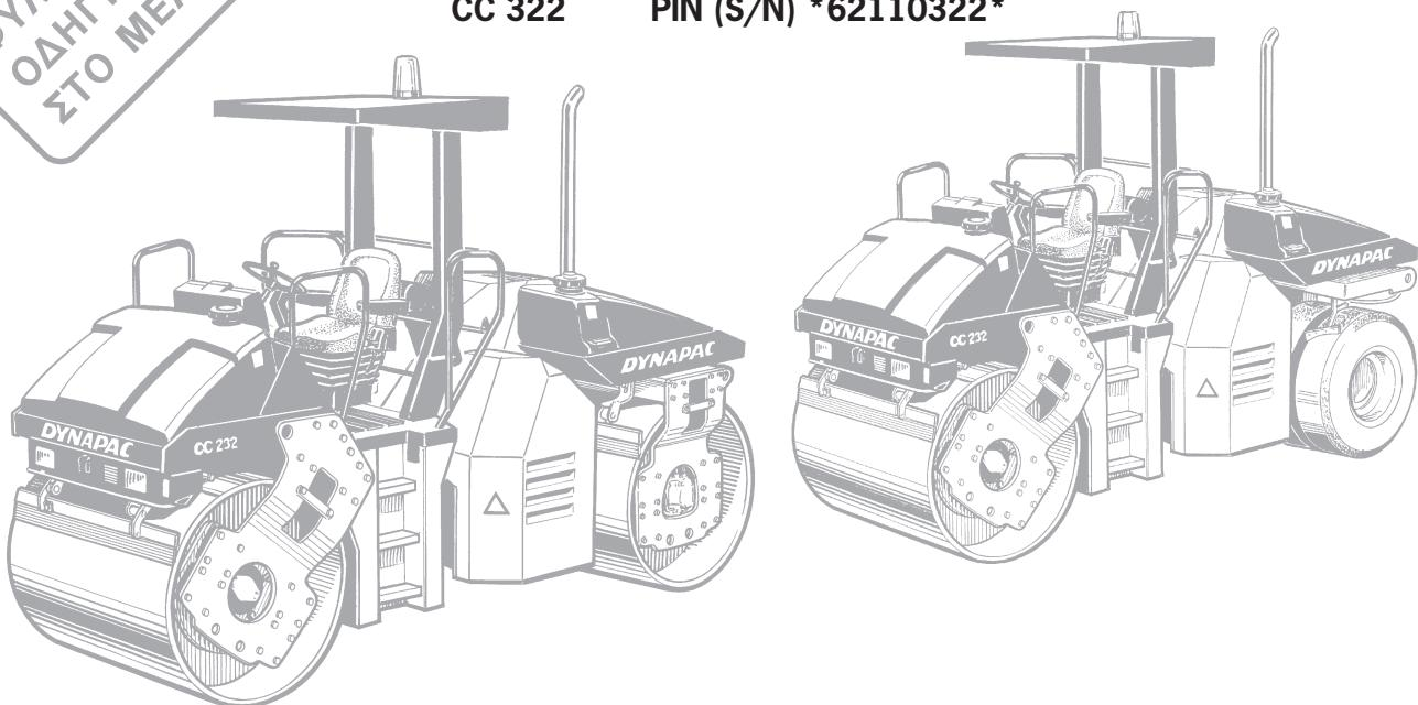
Το Δυναπαψ CC 222 είναι ένας οδοστρωτήρας δόνησης στην κατηγορία των 7,5 τόννων, με σύστημα διεύθυνσης στη μέση και μετάδοση κίνησης, φρένα και δόνηση σε κάθε κύλινδρο.
