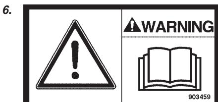
Σύσταση στον οδηγό να διαβάσει το Βιβλίο ασφάλειας και τις οδηγίες οδήγησης και συντήρησης πριν τη χρήση του μηχανήματος.
