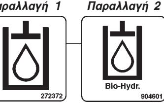
Υδραυλικό λάδι                          Βιο-Υδραυλικό λάδι
