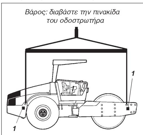
Εικ. 36 Οδοστρωτήρας έτοιμος για ανύψωση
