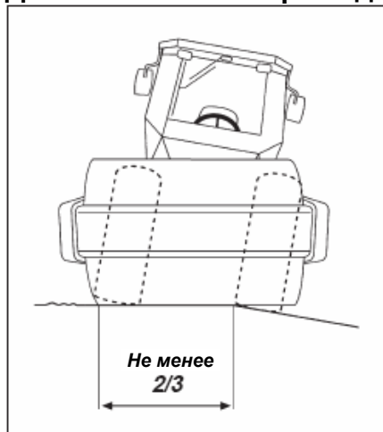
Рисунок 1. Положение вальца при движении вблизи края дорожного полотна
