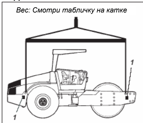
Рисунок 36. Каток готовый к подъему 1. Такелажная табличка
