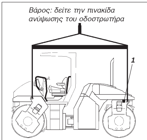
Εικ. 33 Οδοστρωτήρας προετοιμασμένος για ανύψωση 1. Πινακίδα ανύψωσης
