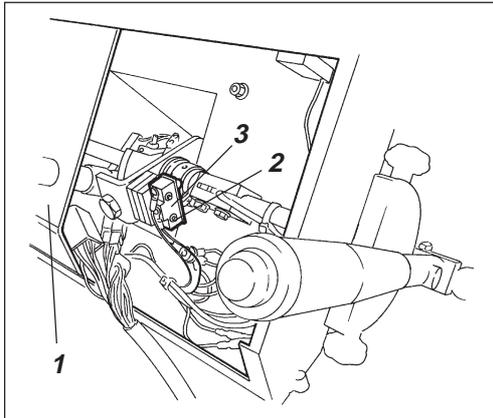
**Fig. 21 Enclenchement de la vibration**
