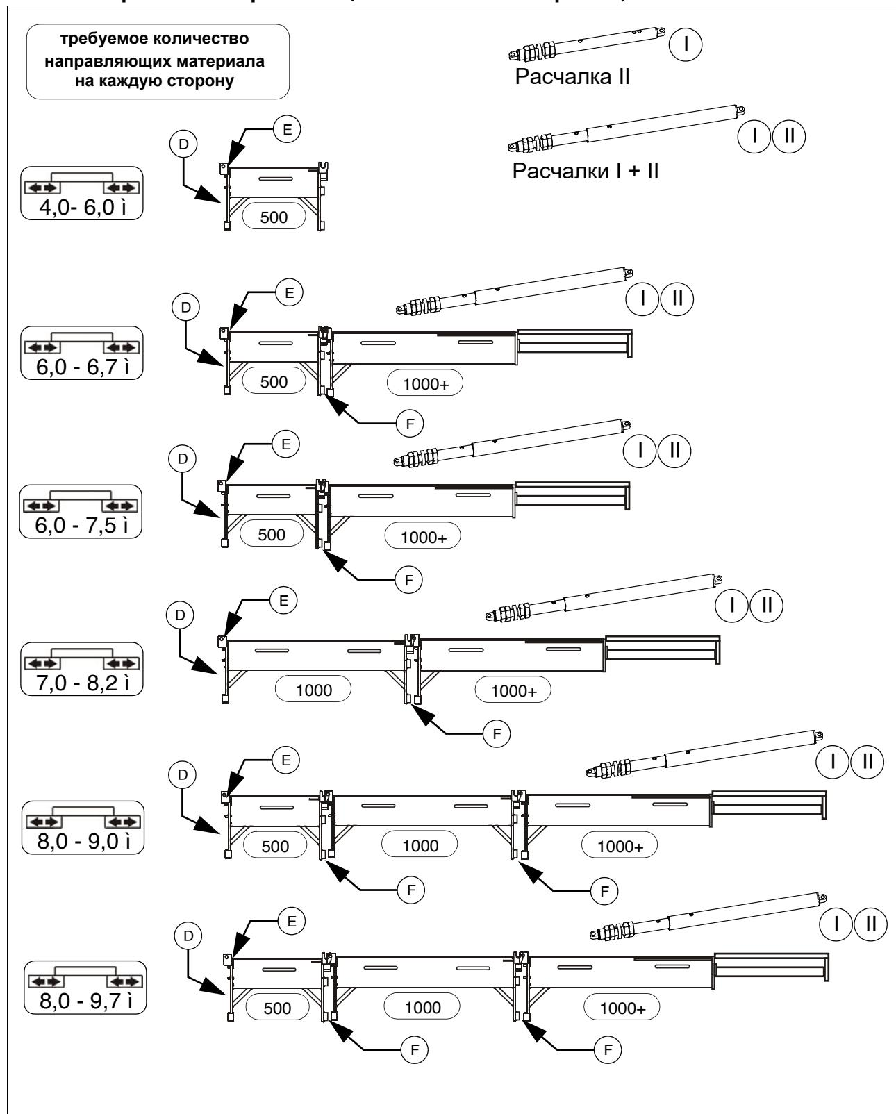
Сразу после установки регулируемой направляющей пластины надо установить расчалку!
