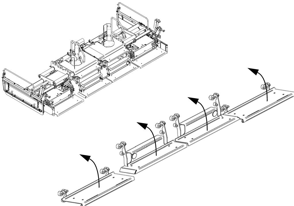
В качестве дополнительного оборудования устанавливаются складные подножки:
