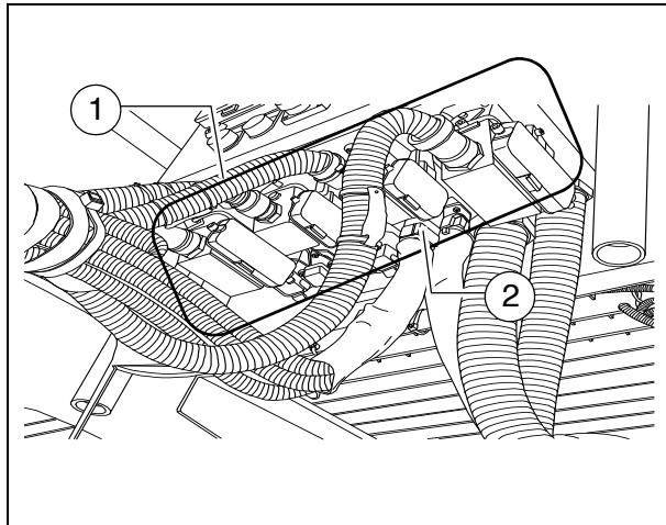
Неиспользуемые вилки и розетки нужно всегда закрывать соответствующими защитными крышками.
