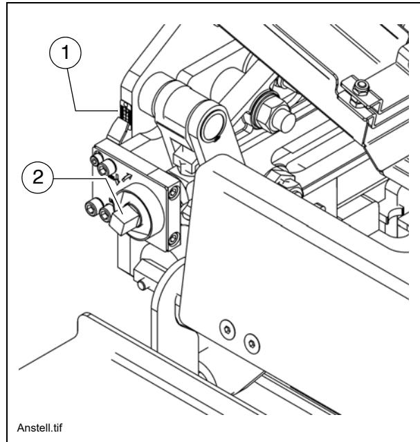
Выдвижные секции устанавливаются таким образом, чтобы они находились на 3 мм выше базовой плиты на внутренней и наружной стороне. Для этого на шкале (1) должно быть установлено значение «0».
