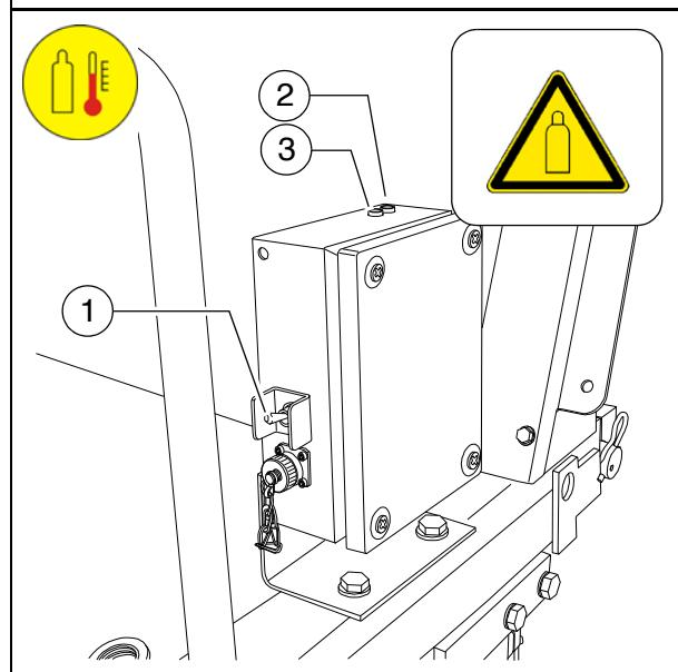
Включение контрольной лампы (2) укажет на то, что система подогрева включена. Неисправность отображается контрольной лампой (3).
