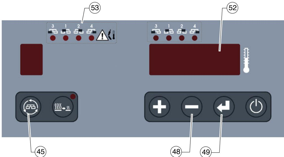
Когда обнаруживается ошибка, загорается сигнальная лампа (53) соответствующей секции выглаживающей плиты и контроллер переходит на программу аварийного режима. Дополнительно включается звуковая сигнализация. Звуковая сигнализация сбрасывается при подтверждении её кнопкой «МИНУС» (48). После нажатия кнопки «ВВОД» на дисплее (52) выводится код ошибки.
