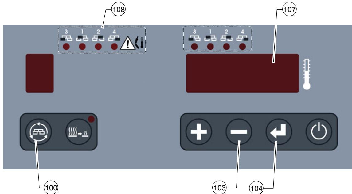
Когда обнаруживается ошибка, загорается сигнальная лампа (108) соответствующей секции выглаживающей плиты и контроллер переходит на программу аварийного режима.
