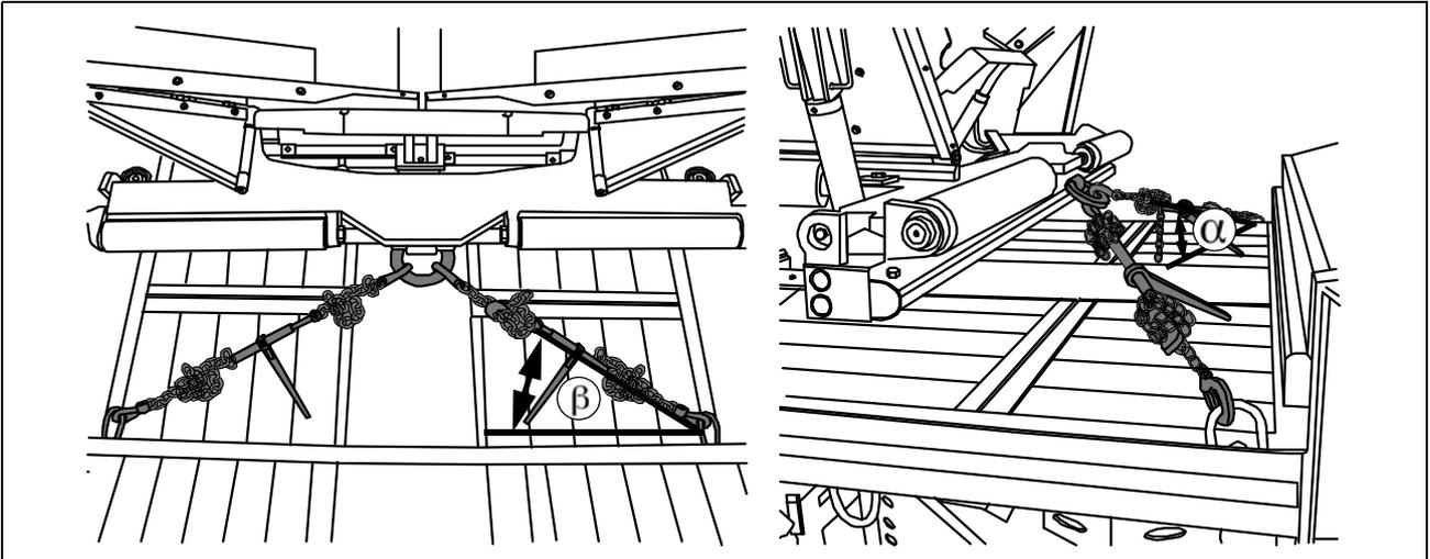
⚠ Die Sicherung vorne ist durch Diagonalzurren des Fertigers durchzuführen. Hierbei sind die Anschlagpunkte am Fertiger sowie am Tieflader zu beachten. Die Zurrketten sind wie dargestellt anzubringen.
