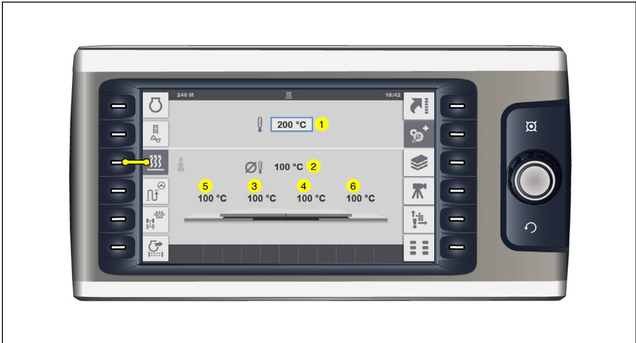
Menü zur Einstellung der Bohlenheizung-Soll-Temperatur und zur Abfrage der Ist-Temperaturen.
