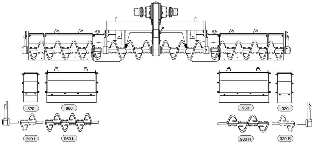
**Schneckenaufrüstung, Arbeitsbreite 5.70m**
