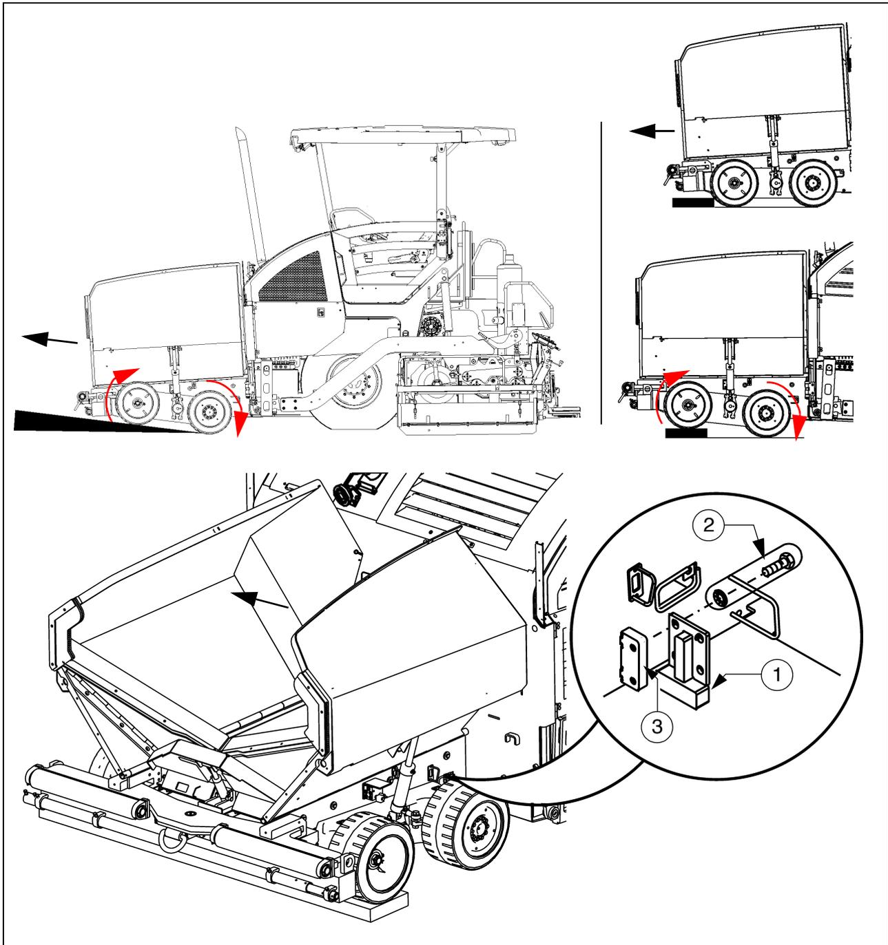
Für Transportfahrten auf öffentlichen Straßen kann die Achslast der Vorderachse reduziert werden. Die pendelnd gelagerte Vorderachse wird mechanisch in einer Position arretiert, so dass nur das hintere Radpaar der Vorderachse auf dem Untergrund aufliegt.
