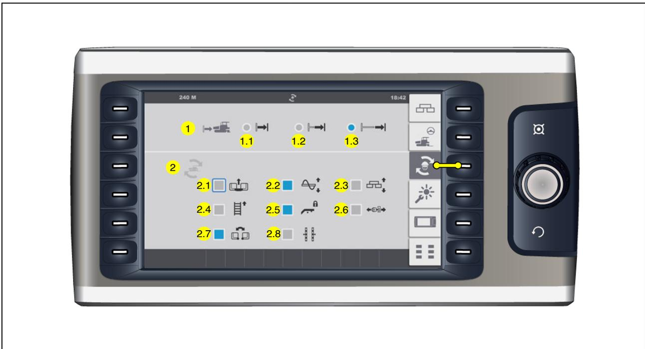
Menü zur Einrichtung Funktionen „Truck Assist“ und „Set Assist“.
