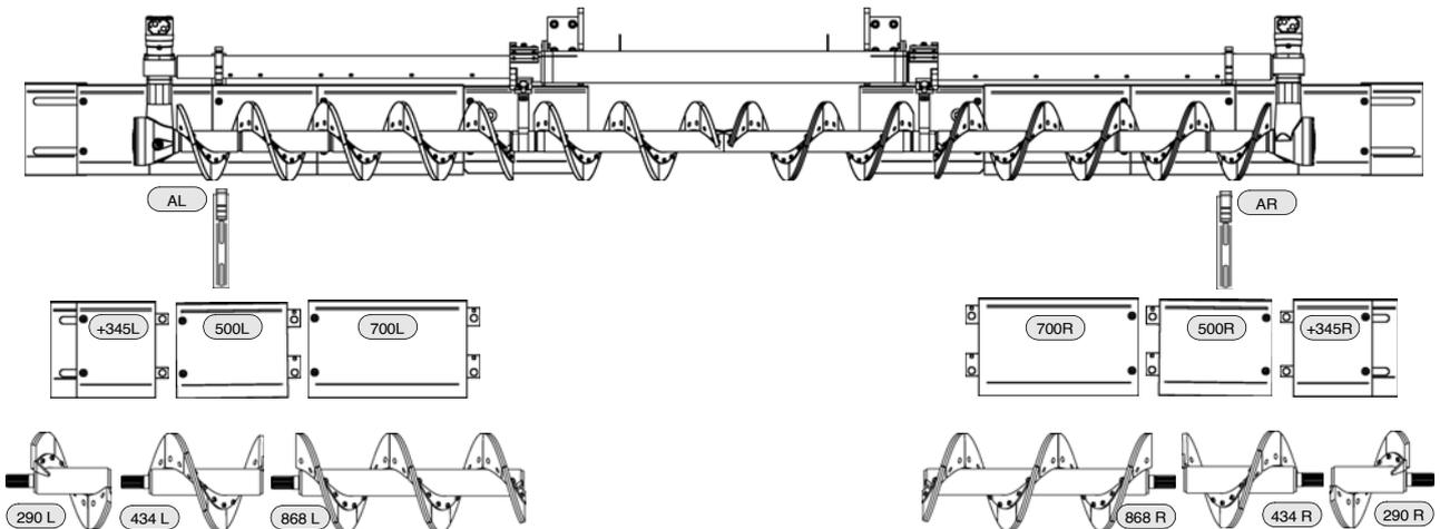
**Schneckenaufrüstung, Arbeitsbreite 6.53m**
