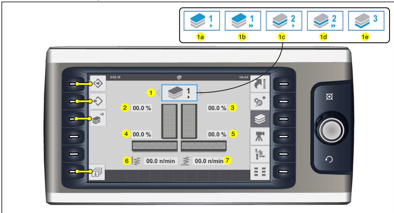
Menü zur Anzeige und Einstellung von Einbauparametern.
