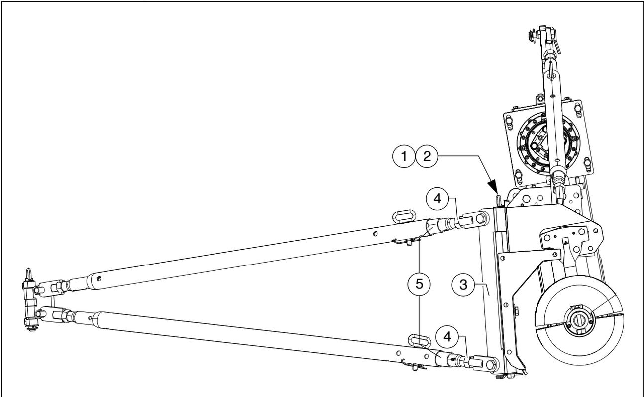
Die Höhenverstellung der Schnecke kann bei großen Arbeitsbreiten mit angeschlagener Abstrebung vorgenommen werden:
