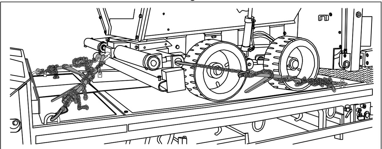
⚠ Die Sicherung vorn und seitlich ist durch Diagonalzurren des Radfertigers durchzuführen. Hierbei sind die Anschlagpunkte am Fertiger sowie am Tieflader zu beachten. Die Zurrketten sind wie dargestellt anzubringen.
