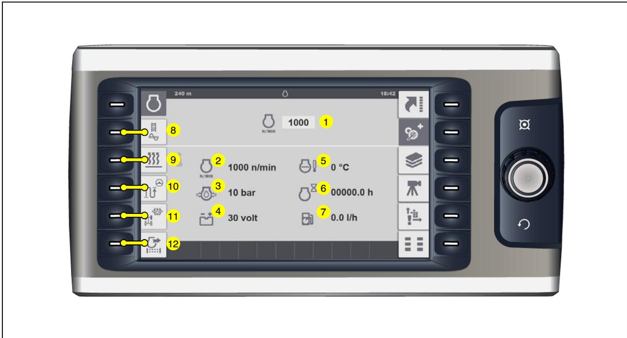
Menü zur Einstellung der Motordrehzahl und zur Abfrage verschiedener Messwerte des Antriebsmotors.
