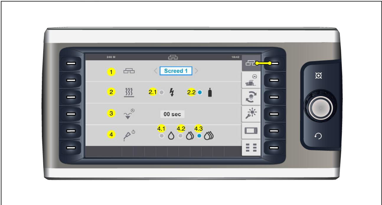
Menu pour le paramétrage des réglages de base de la table et des fonctions de la table.
