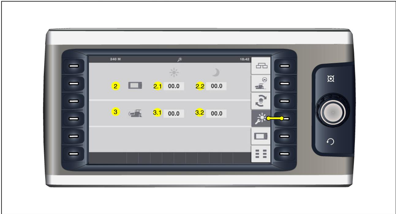
Menu de paramétrage de l'intensité lumineuse de différents éléments de commande.
