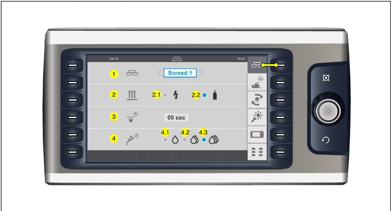
Menú para el ajuste de la configuración básica de la regla y las funciones de la regla.
