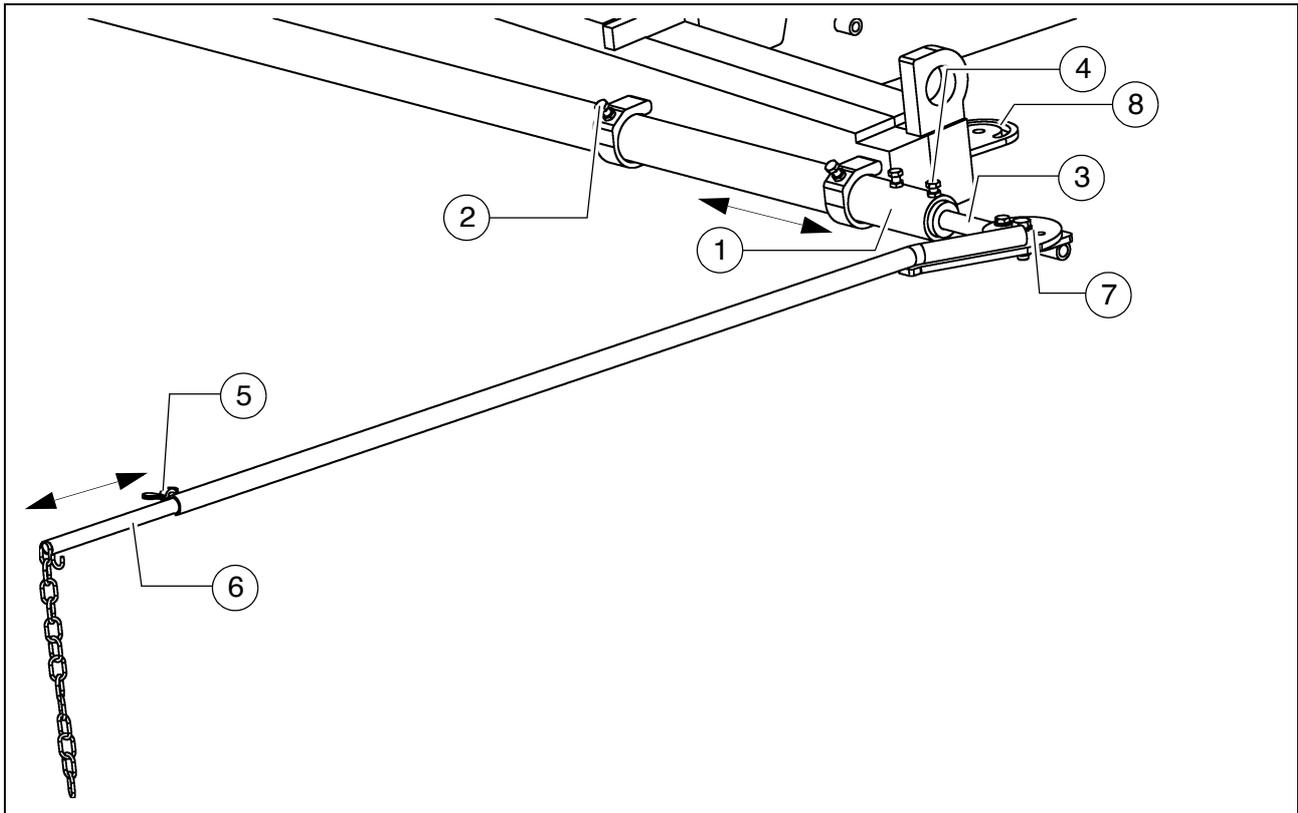
La varilla de sonda sirve como ayuda de orientación para el conductor de la máquina durante la pavimentación.
