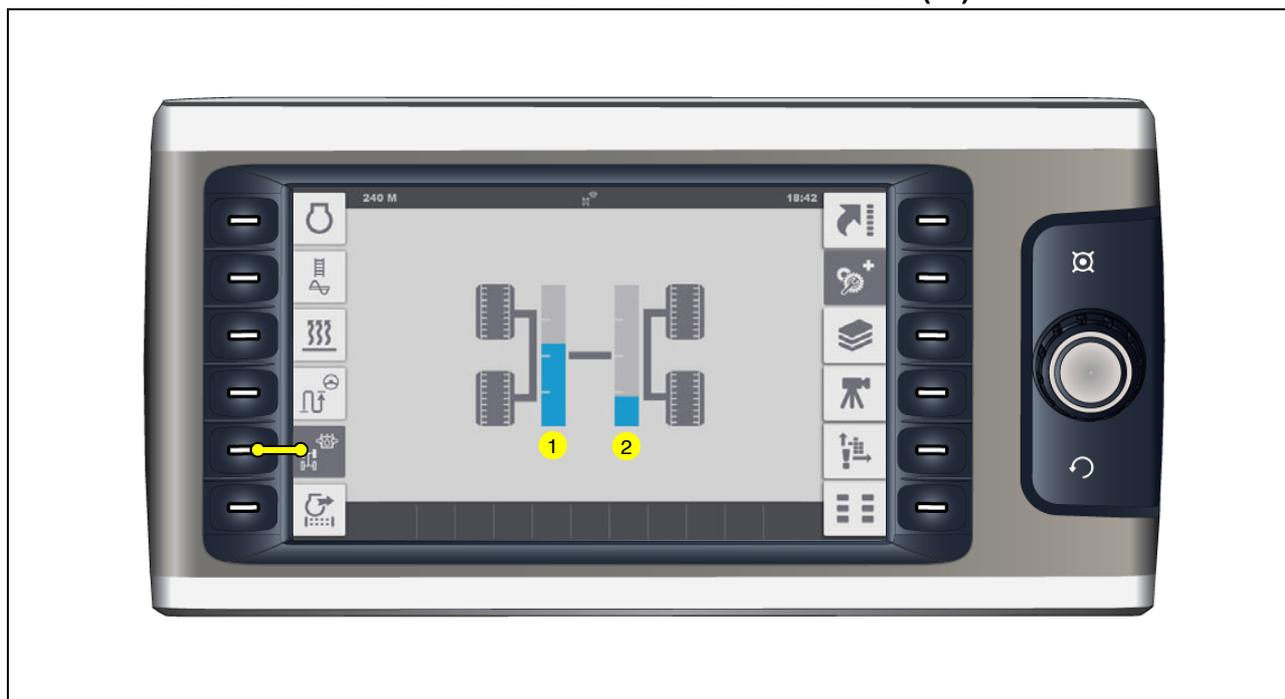
Indicación de la potencia puesta a disposición de la tracción delantera.
