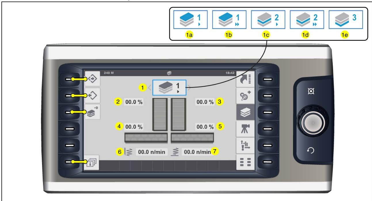
Menú para la indicación y el ajuste de los parámetros de pavimentación.
