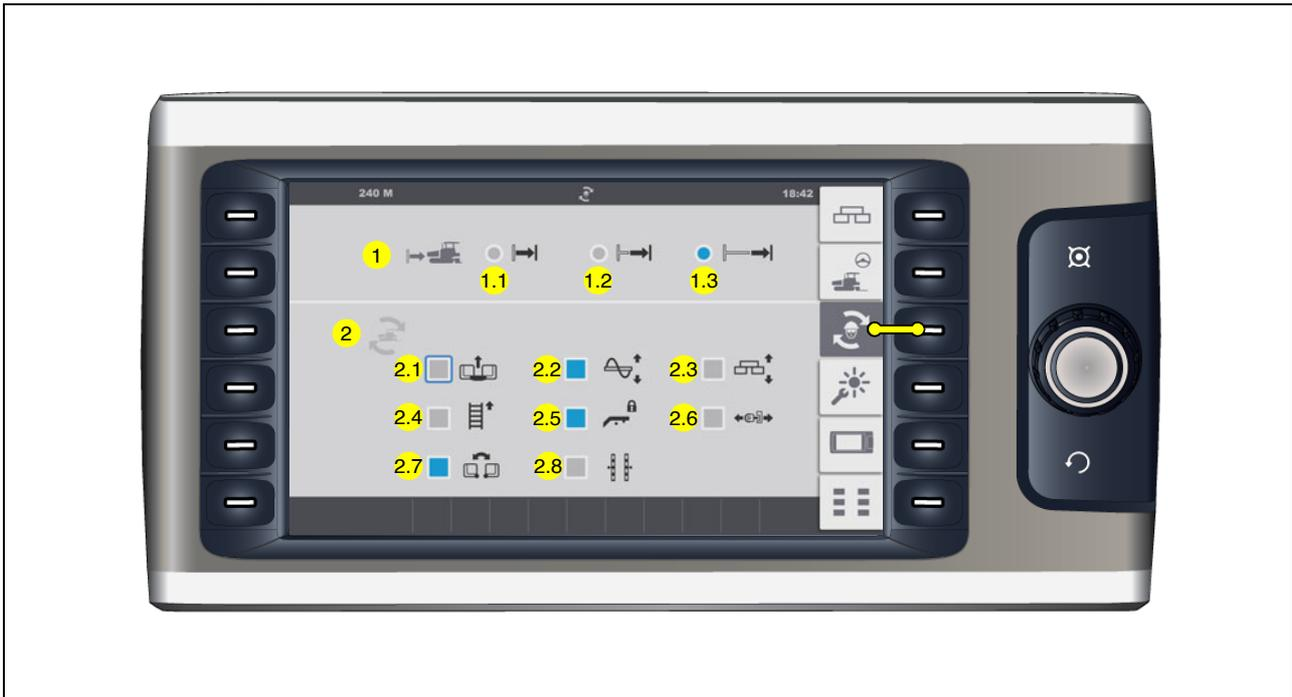
Menú para el ajuste de las funciones "Truck Assist" y "Set Assist"
