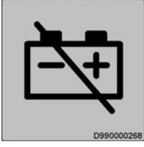
D990000268 | - <b>Разъединительный выключатель аккумуляторов</b><br>Позиция разъединительного выключателя аккумуляторов. |
