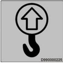
D990000225   | - <b>Точка подъема</b><br>Подъем машины разрешен только за эти точки строповки!                             |
