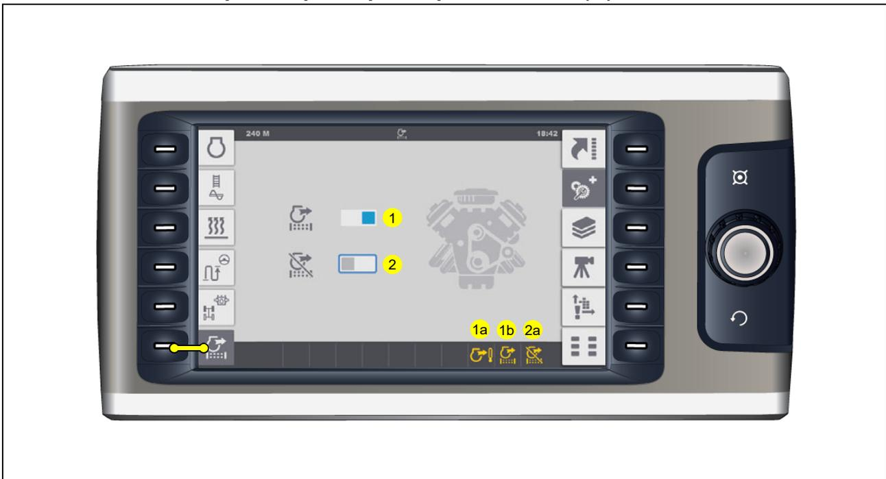
Меню для включения требуемой активной регенерации фильтра и блокировки автоматической регенерации фильтра.
