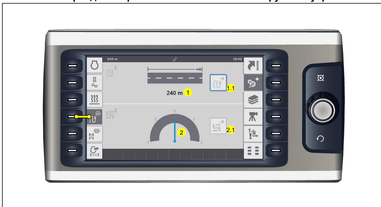
Меню для считывания и сброса актуального пройденного расстояния, а также отображения мониторинга руления и сброса референции мониторинга руления.
