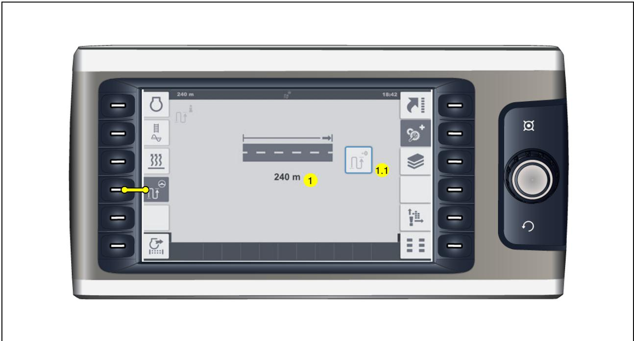
Menü zur Abfrage und zum Reset der aktuellen Einbaustrecke.
