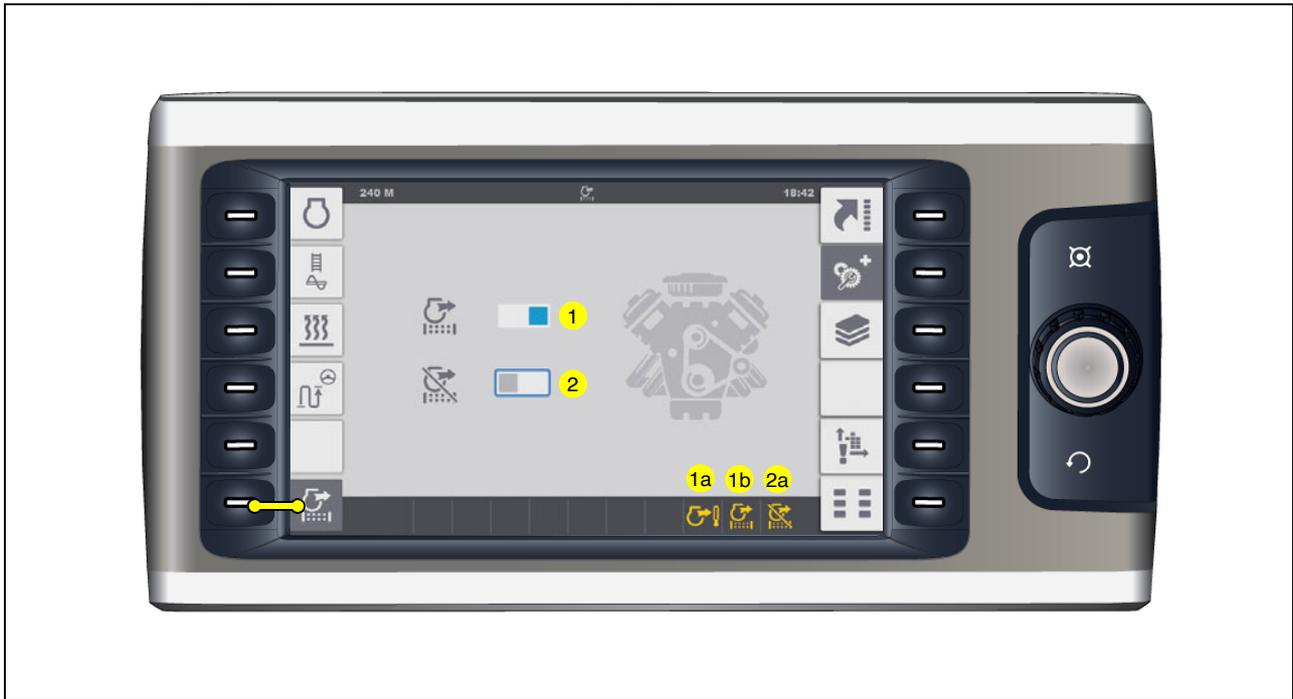
Menü zur Auslösung einer angeforderten aktiven Filter-Regeneration und zur Sperrung der automatischen Filter-Regeneration.
