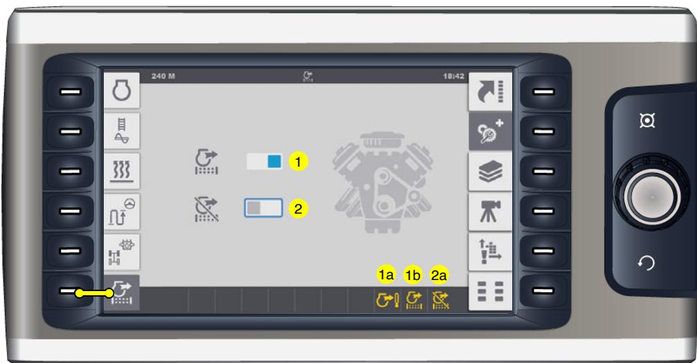
Meny för att utlösa en begärd aktiv filterregenerering och att spärra den automatiska filterregenereringen.
