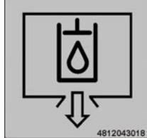
4812043018 | <ul style="list-style-type: none"> <li>- <b>Motoroljans avtappningspunkt</b><br/>Avtappningspunktens läge.</li> </ul>     |
