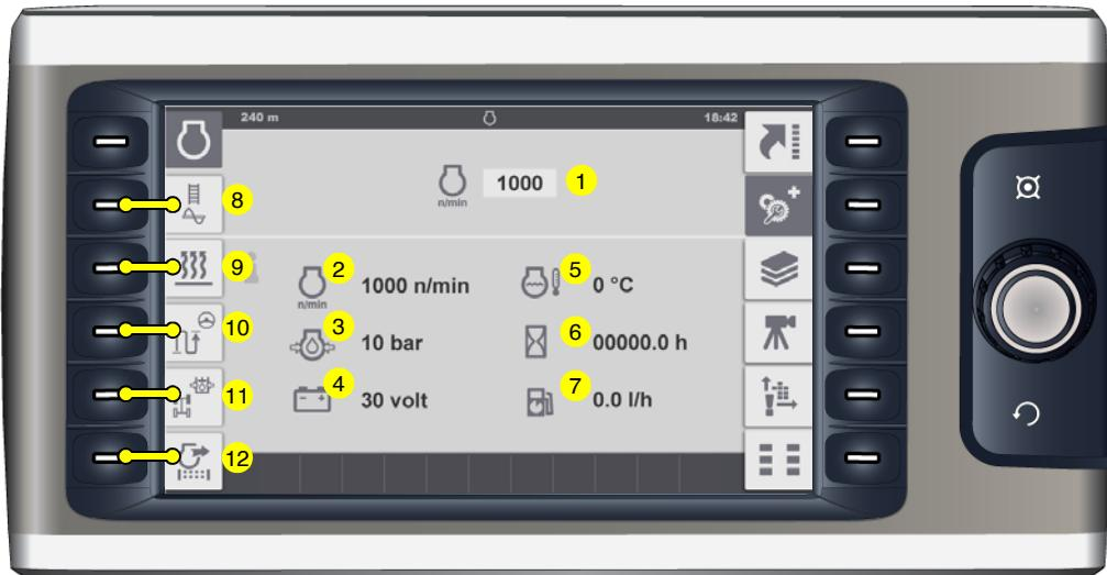
Meny för att ställa in motorvarvtal och för att avfråga olika mätvärden på drivmotorn.
