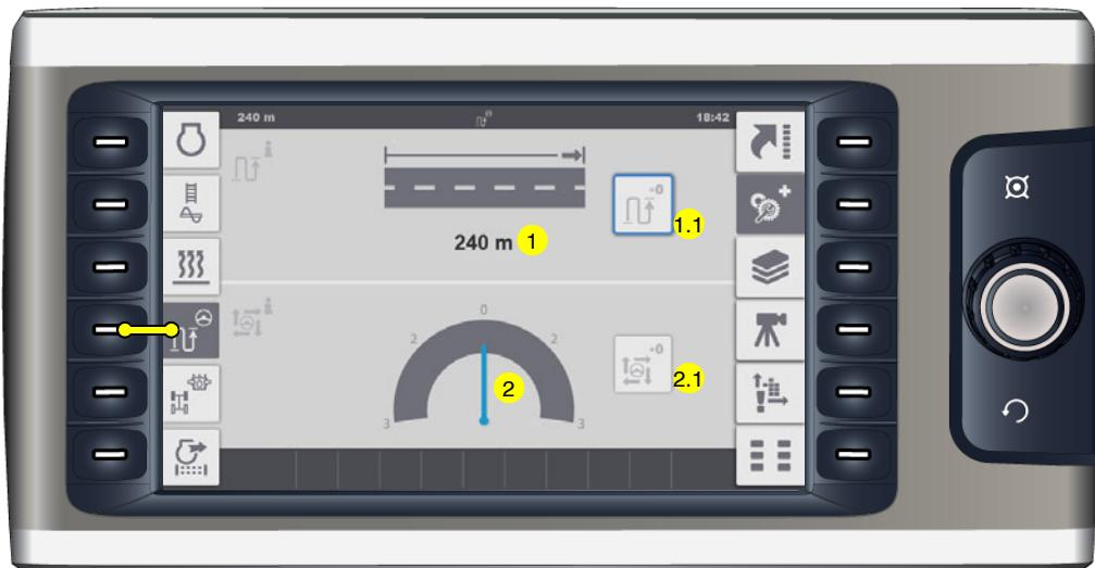
Meny för avfrågning och reset av aktuell utläggningssträcka samt för visning av styrövervakningen och rest av styrövervakningens referens.
