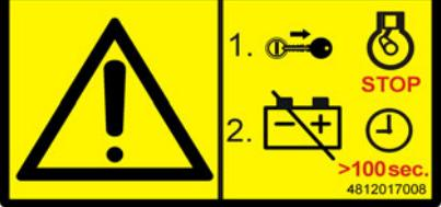
4812017008 | <ul style="list-style-type: none"> <li><b>Varning - Möjliga skador på motorelektroniken</b><br/>Efter att drivmotorn stängts av får ombordspänningen kopplas ifrån först efter &gt; 100 sekunder (huvudströmbrytare).<br/>Beakta instruktionsboken!</li> </ul>                                              |
