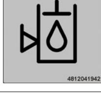
4812041942 | <ul style="list-style-type: none"> <li>- <b>Hydrauloljenivå</b><br/>Läge kontrollpunkt.</li> </ul>                        |
