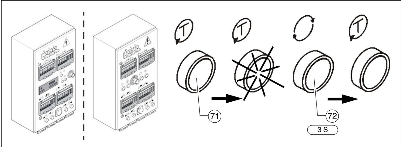
Todos os dias, antes do início do serviço, é necessário testar a operacionalidade do dispositivo de protecção encarregado de monitorizar o isolamento.
