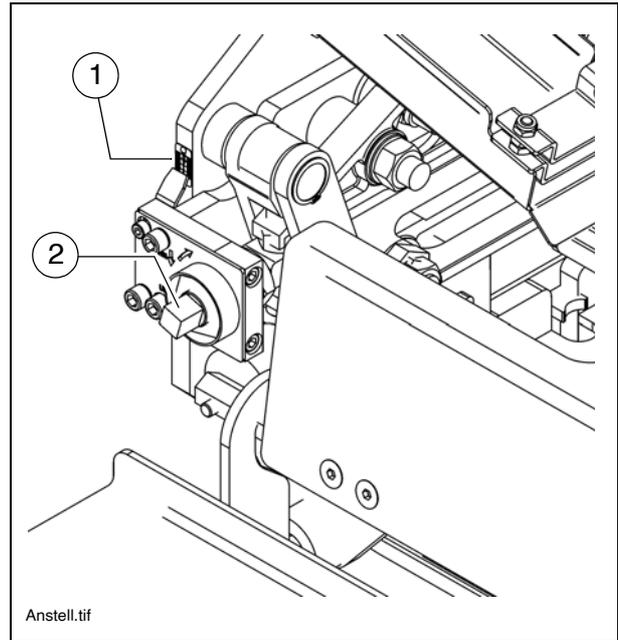
Os elementos projectantes vêm regulados de fábrica de maneira a que, quer do lado de dentro, quer do lado de fora, fiquem 3 mm acima da pá básica. No caso desta regulação, as escalas (1) encontram-se no "0".
