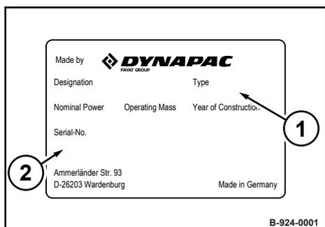
Fig. 1: Placa de características da máquina (exemplo)
