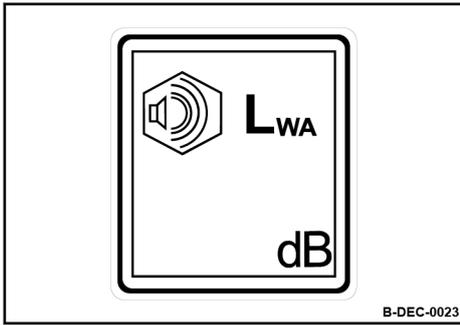
Hinweisschild - garantierter Schallleistungspegel
