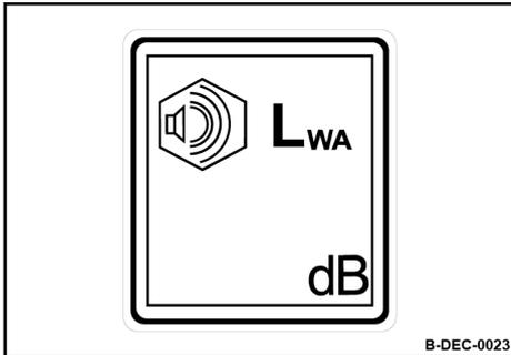
Hinweisschild - garantierter Schalleistungspegel
