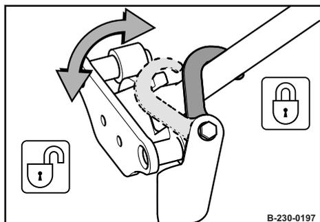
Zum Lösen oder Festsetzen des Führungsbügel Mitte beim Transport.
