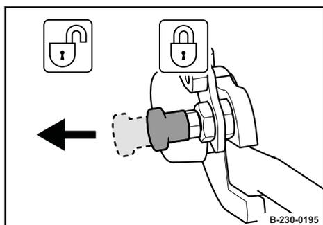
Zum Lösen oder Festsetzen des Führungsbügel beim Transport.
