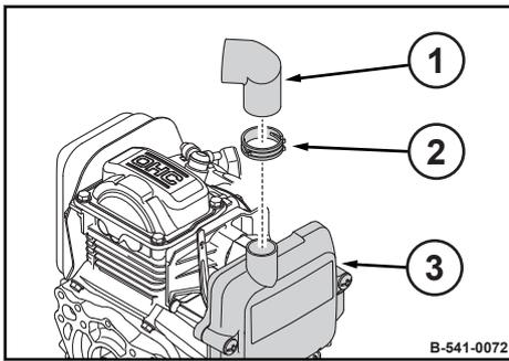
18. Luftführungsschlauch (1) mit Schlauchschelle (2) am Deckel (3) montieren.
