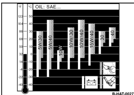
Bild 59: Ölviskositätsdiagramm
