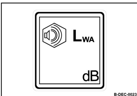
Hinweisschild - garantierter Schallleistungspegel
