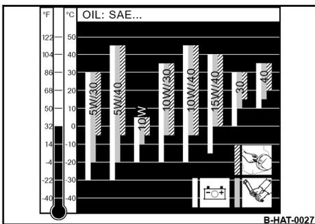
Bild 51: Ölviskositätsdiagramm
