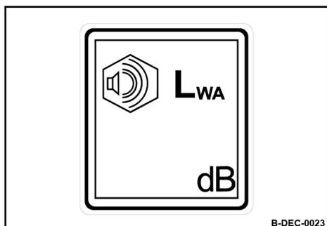
Hinweisschild - garantierter Schallleistungspegel
